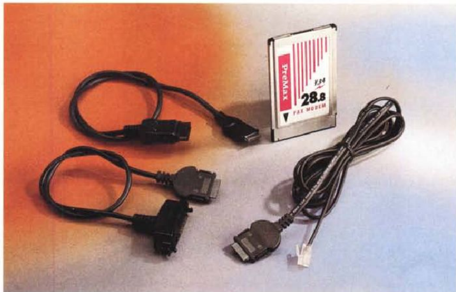
Ecco tutto l'occorrente: il modem ed una serie completa di cavetti; sulla sinistra quelli per il collegamento a due diversi telefonini; sulla destra il cavo standard per la presa telefonica a muro.
